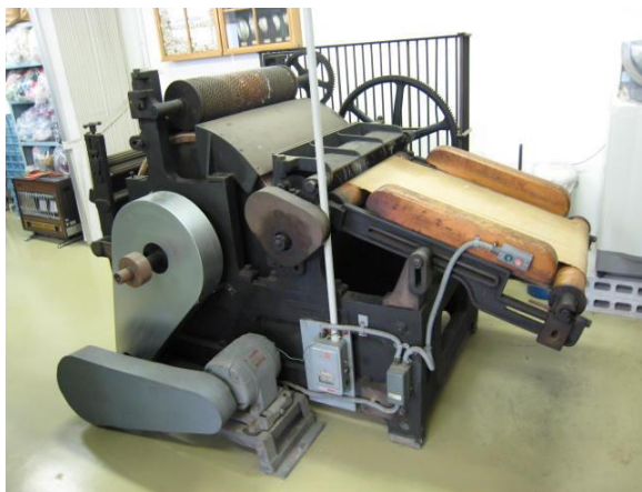
開綿機（かいめんき） 工程の最初の機械です。
