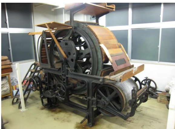
円型梳綿機（えんけい そめんき） これだけが国産で、石井鐵工所製。高さが約2.5メートルあります。
