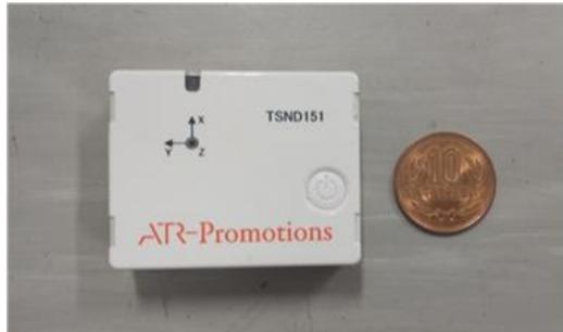
Fig. 2 IMU sensor
