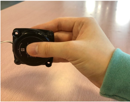
Fig. 1: 振動子を持ち上げた様子. 参加者は重力と垂直な方向に振動が提示されるように振動子を持ち上げた.
